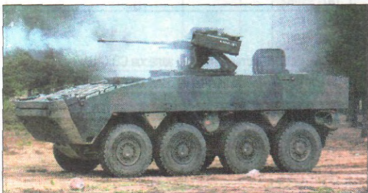
БММ АМВ, оснащенная обитаемой башней (вверху) и дистанционно управляемым модулем вооружения «Самсон» израильской фирмы «Рафазль» (внизу)
